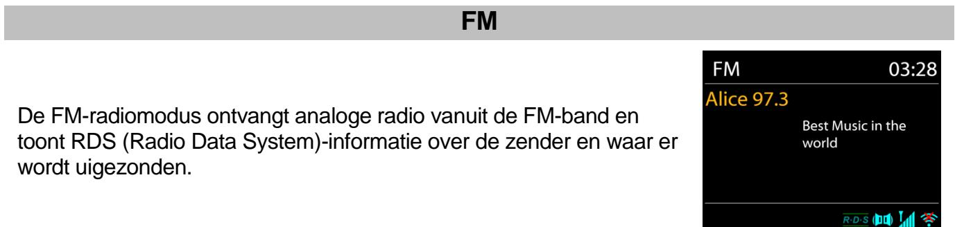
De FM-radiomodus ontvangt analoge radio vanuit de FM-band en toont RDS (Radio Data System)-informatie over de zender en waar er wordt uitzonden.
