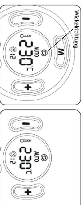
Wenn Sie **LINKS** einstellen, werden die Locken nach links gewickelt; Bei Einstellung auf **AUTO** ist die Wickelrichtung abwechselnd, bei Einstellung nach **RECHTS** werden die Locken nach rechts gewickelt.
